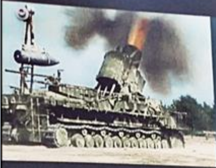
Gigantyczny, 124-tonowy niemiecki moździerz typu „Karl”, kalibru 600 mm, ostrzeliwujący Warszawę podskami ważył 2,2 tony. Krater po wybuchu takiego ładunku miał 5 metrów głębokość i 13 metrów średnicy. Fot. domena publiczna; koloryzacja: Mikolaj Kaczmarek
